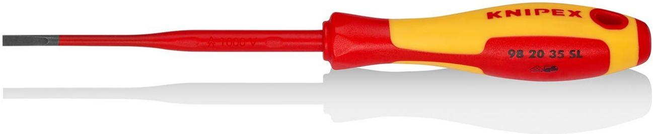
Schraubendreher (Slim) für Schlitzschrauben: Reduzierter Klingenisolationsdurchmesser für tiefliegende Feder- und Schraubelemente.: Ergonomisch optimierter 2-Komponenten-Griff für ermüdungsarme und handschonende Kraftübertragung. Rollhemmende Griffform. - Klingenlänge: 100mm - unisolierte Klingenlänge: 15mm - Grifflänge: 102mm - Schneidenbreite: 3,5mm - Schneidendicke: 0,6mm - VDE-geprüft: Ja
