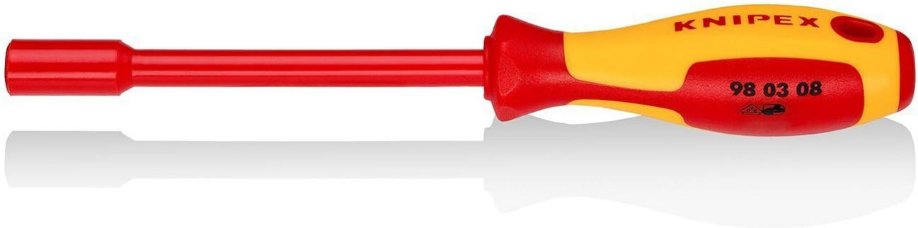
Ergonomisch optimierter 2-Komponenten-Griff für ermüdungsarme und handschonende Kraftübertragung. Rollhemmende Griffform. - Schlüsselweite S: 8,0mm - Grifflänge max.: 112mm - Kopfdurchmesser d: 15mm Klingenlänge 125mm - VDE-geprüft: Ja
