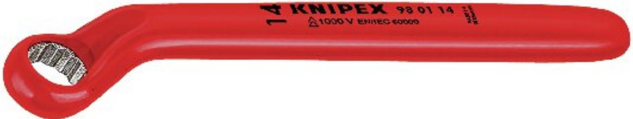
Gekröpft. Grundwerkzeug verchromt. - Schlüsselweite: 24mm - Länge l max.: 265mm - Kopfstärke a max.: 16mm - Höhe der Verkröpfung h max.: 30mm - Kopfbreite b max.: 38mm
