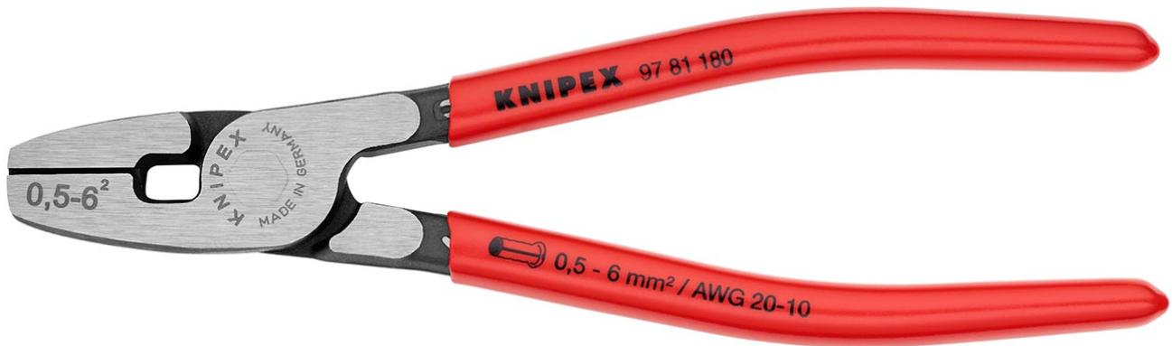
für Aderendhülsen: Zum Verpressen von Aderendhülsen nach DIN 46228 Teil 1 + 4 im Bereich 0,5 bis 6 mm<sup>2</sup>. Vorteilhaft einsetzbar für Arbeiten an schwer zugänglichen Stellen, z. B. in engen und tiefen Schaltschränken. - Anwendung: Aderendhülsen - Kapazität Quadratmillimeter: 0,5 - 6,0mm<sup>2</sup> - Anzahl der Nester: 1 - AWG: 20 - 10
