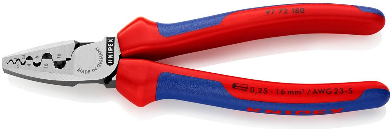
für Aderendhülsen: leichte und schlanke Bauweise. auch als VDE-Version. leichtes Crimpen durch optimierte Übersetzung. Zum Verpressen von Aderendhülsen nach DIN 46228 Teil 1 + 4 im Bereich von 0,25 bis 16 mm<sup>2</sup>. Verpressung in gekennzeichneten Halbrundprofilen für die sichere Verbindung von Hülse und Leiter. Neun besonders tiefe Profile mit konischen Seitenflächen. - Anwendung: Aderendhülsen - Kapazität Quadratmillimeter: 0,25-16,0mm<sup>2</sup> - Anzahl der Nester: 9 - AWG: 23 - 5
