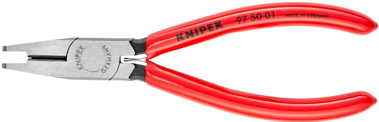
Crimpzange für Scotchlok™-Verbinder Zum Verpressen von kunststoffisolierten Fernmelde- oder Signal-Kabeladern nach dem U-Kontakt-Prinzip in Scotchlok™-Einzelverbindern. Kein Abisolieren, U-Elemente übernehmen die Kontaktierung. Schneiden zusätzlich induktiv gehärtet, Schneidenhärte ca. 60 HRC. Mit Öffnungsfeder. - Anwendung:
