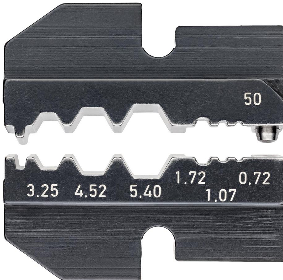
Anwendung: Koax-Verbinder/Auto-Telefon RG 58, 174, 188, 316 Hülsen: 3,9, 5,4, 6,4, 2,1, 1,3, 0,95. - Nennmaß: RG 58 / 174 / 188 / 316 - Anwendung: Koaxial-Verbinder/Auto-Telefon RG 58, 174, 188, 316 - Anzahl der Nester: 6
