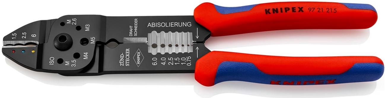
Zum Kabelschneiden, Abisolieren von Drähten und Crimpen von isolierten und unisolierten Kabelschuhen und Steckverbindern und offenen Steckverbindern. Mit Gewindelöchern zum Abschneiden von Cu- oder Ms-Gewindestiften mit M 2,6; M 3; M 3,5; M 4 und M 5. Geschraubtes Gelenk für eine hohe Stabilität und gleichmäßigen Lauf. - Anwendung: isolierte Kabelschuhe + Kabelverbinder - Kapazität Quadratmillimeter: 0,5 - 6,0mm<sup>2</sup> - Anzahl der Nester: 3 - AWG: 20 - 10
