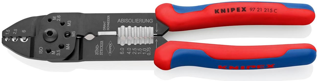
Zum Kabelschneiden, Abisolieren von Drähten und Crimpen von isolierten und unisolierten Kabelschuhen und Steckverbindern und offenen Steckverbindern. Mit Gewindelöchern zum Abschneiden von Cu- oder Ms-Gewindestiften mit M 2,6; M 3; M 3,5; M 4 und M 5. Geschraubtes Gelenk für eine hohe Stabilität und gleichmäßigen Lauf. - Anwendung: unisolierte Kabelschuhe + Kabelverbinder - Kapazität Quadratmillimeter: 0,5 - 6,0mm<sup>2</sup> - Anzahl der Nester: 3 - AWG: 20 - 10
