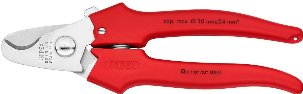
Nicht für Stahldraht und hartgezogene Kupferleiter geeignet. Gehärtete Schneiden mit Präzisionsschliff. Kein Quetschen, geringe Verformung des Kabels. Klemmschutz verhindert Quetschverletzungen. Nachstellbares Schraubgelenk. zum Schneiden von Kabeln Ø 10 mm / 24 mm<sup>2</sup>. Mit Öffnungs feder und Sperrklinke. Schneiden aus rostfreiem Stahl. in Öl gehärtet und angelassen. - Schneidwert Cu-Kabel, mehrdrähtig: 24mm<sup>2</sup> - Schneidwert Cu-Kabel, mehrdrähtig: Ø 10mm - AWG: 3
