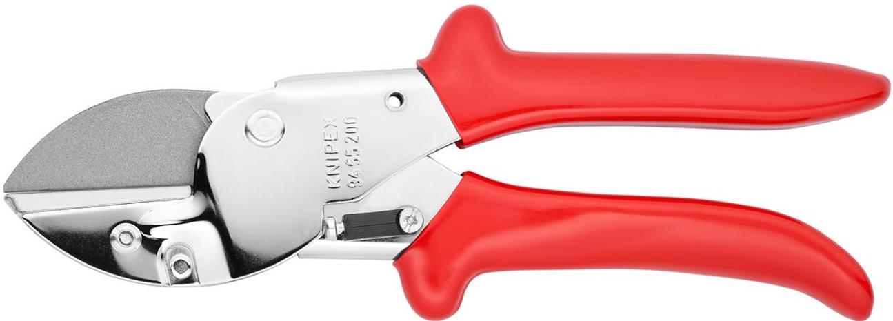
Ziehender Schnitt gegen feste Unterlage zum quetschfreien Schneiden von weichen Materialien wie z. B. Gummi-Profile, PVC, Leder, Holz, Schläuche, usw.. Schneidet Flachmaterial bis max. 40 mm Breite und 7,5 mm Höhe. Schneidkapazität für Rundmaterial bis  $\varnothing$  25 mm. Robuste, auswechselbare Klinge. Mit Öffnungsfeder und Sperrklinke.
