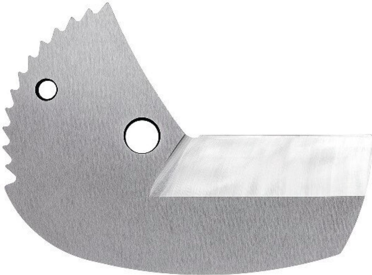
Ersatzmesser für 90 25 40 Zum Schneiden dickwandiger Kunststoff- und Verbundrohre. Schneidet Rohre nach dem Ratschenprinzip durch mehrere Hübe. Mit beweglichen Auflagebacken zur richtigen Fixierung des Rohres für einen rechtwinkligen Schnitt.
