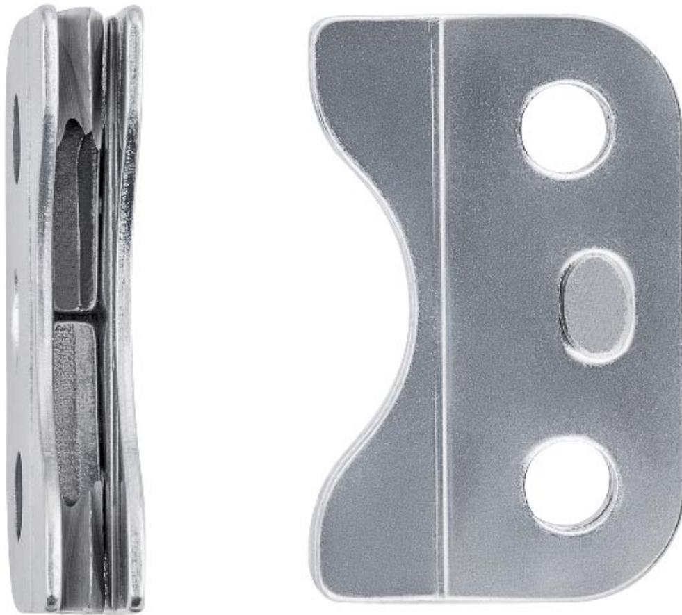
1 Paar Ersatzmesser für 90 25 20 (Schutzrohre) Zum Schneiden von Verbundrohren  $\varnothing$  12,0 bis 25,0 mm und zum Schneiden von flexiblen Schutzrohren  $\varnothing$  18,0 bis 35,0 mm ohne das innenliegende Rohr zu verletzen. Möglichkeit zur Anbringung eines Kalibrierdorns z. B. für Geberit-Verbundrohre  $\varnothing$  11,5 und 15,0 mm.
