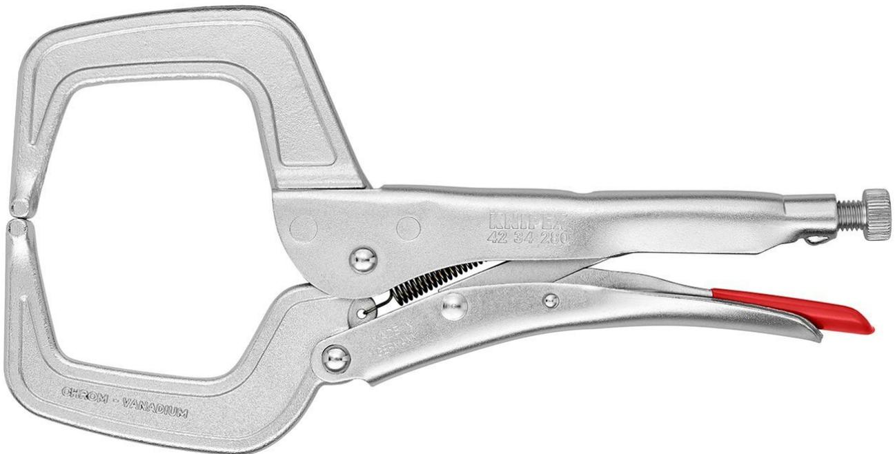
Zum Klemmen, Spannen und Halten von diversen Profilen. Hoch belastbar. Mit Stellschraube und Lösehebel. Einhandbedienung. Hoher Spanndruck durch Kniehebelübersetzung. Greifbacken aus Chrom-Vanadin-Stahl, gesenkgeschmiedet. spannt sperrige Werkstücke und Profile mit hohen Stegen bis zu 40 mm. - Spannkapazität 4-kant: 90mm
