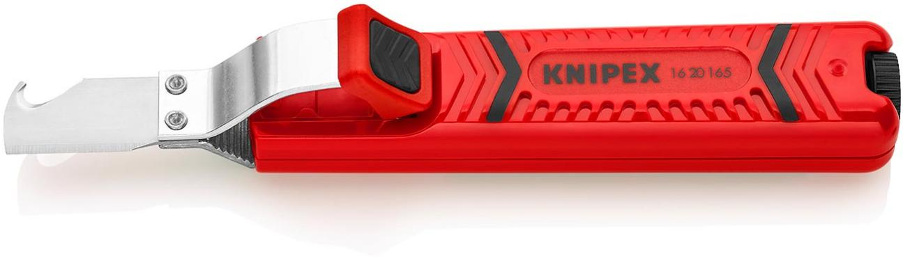
Zum Abmanteln aller gängigen Rundkabel. Selbstspannender Festhaltebügel. Mit Schnitttiefeinstellung per Einstellschraube. Selbstdrehende Schleppklinge für Umfangs- und Längsschnitt. Reserveklinge im Gehäuse. Griffsicherheit durch Weichkomponenten-Einlage als Abrutschschutz an Griff und Festhaltebügel. Messer mit gerader Schneide und Hakenklinge inkl. Schutzkappe. - Abisolierwerte (Durchmesser): Ø 8,0 - 28,0mm
