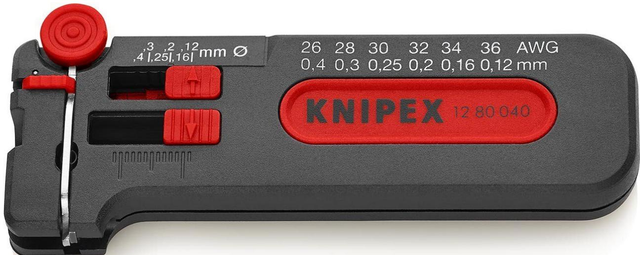
Präzises Abisolieren durch stufenweise Einstellung des Werkzeugs auf den Leiterdurchmesser. Mit Drahtschneider. Mit Längenanschlag: einstellbar von 4,0 bis 15,0 mm. Mit Sperrklinke. für dünne Cu-Leiter Ø 0,12 bis 0,4 mm. - Abisolierwerte (Durchmesser): Ø 0,12 - 0,4mm - AWG: 36 - 26
