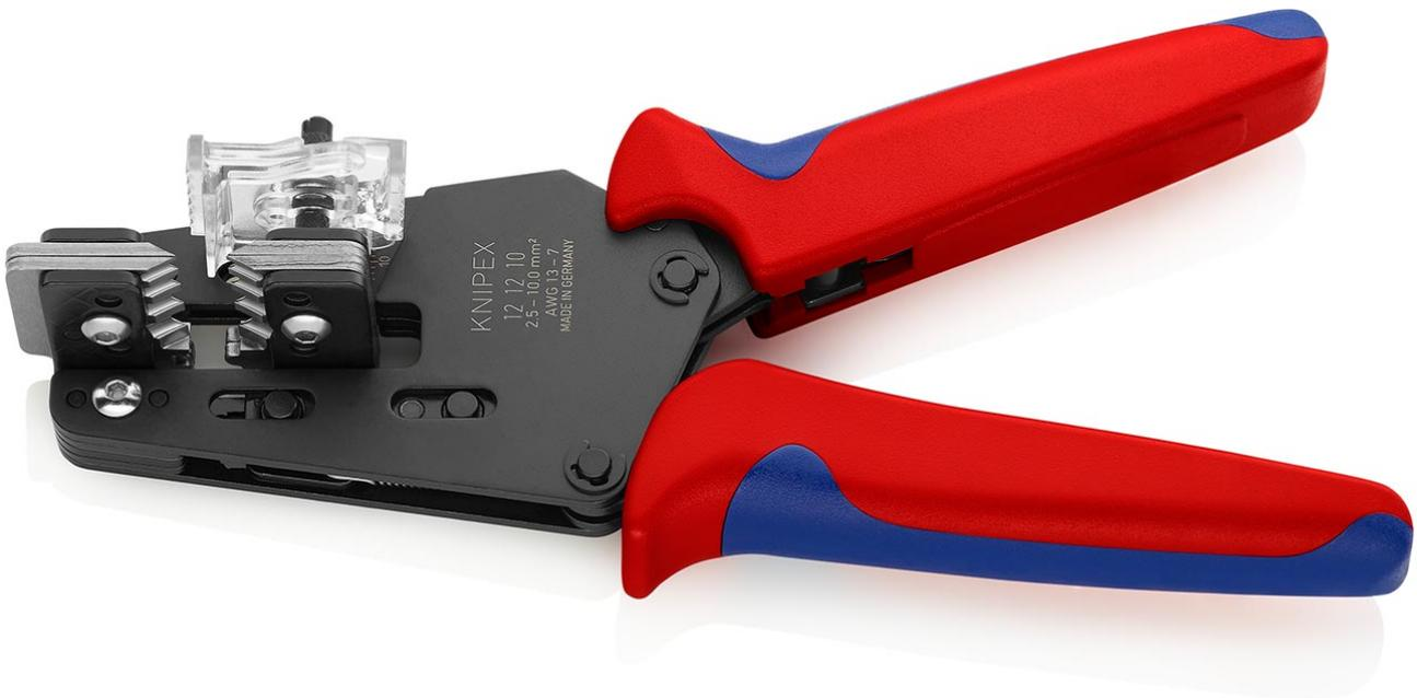
Formschlüssiges Abisolieren auch von schwer zu entfernenden Isolierwerkstoffen aus PTFE, Silikon, Radox®, Kapton® und Gummi; auch mehrlagig. Ein zweites Messerpaar hält die verbleibende Isolierung zuverlässig fest. Genau auf den jeweiligen Leiterquerschnitt abgestimmte, auswechselbare Formmesser. Mit einstellbarem Längenanschlag für gleiche Abisolierlängen bei Serienarbeit. - Abisolierwerte Quadratmillimeter: 2,5 / 4,0 / 6,0 / 10,0mm<sup>2</sup> - AWG: 13 - 7
