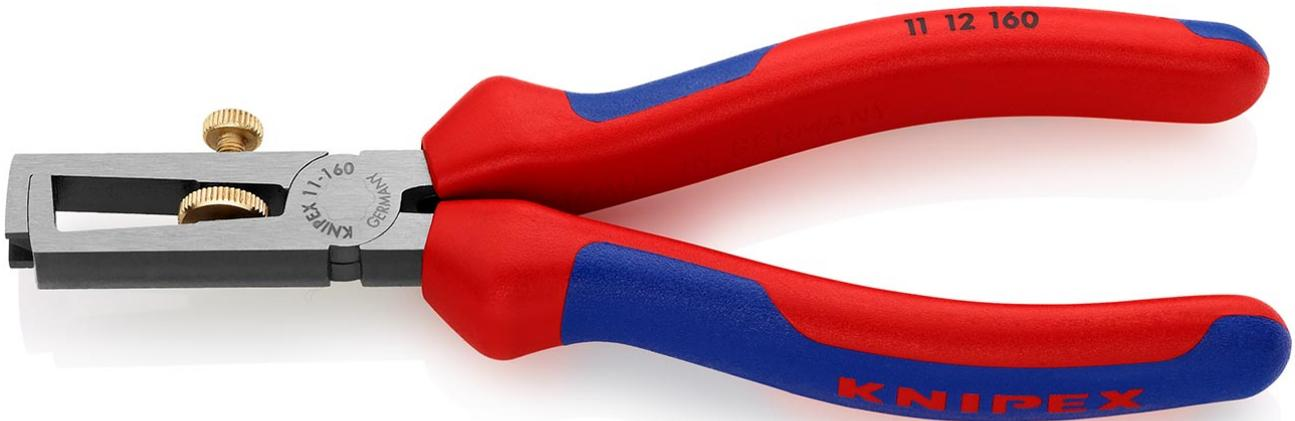
Für ein-, mehr- und feindrähtige Leiter mit Kunststoff- oder Gummiisolation max. Ø 5 mm oder 10 mm<sup>2</sup> Leiterquerschnitt. Einfache Verstellung auf den gewünschten Draht- oder Litzendurchmesser durch Rändelschraube und Kontermutter. - Form: 1 - Abisolierwerte Quadratmillimeter: 10mm<sup>2</sup> - Abisolierwerte (Durchmesser): Ø 5,0mm - AWG: 7
