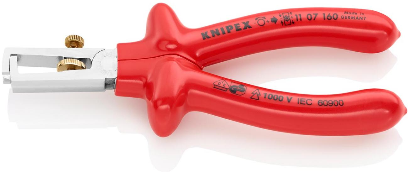
Für ein-, mehr- und feindrähtige Leiter mit Kunststoff- oder Gummiisolation max. Ø 5 mm oder 10 mm<sup>2</sup> Leiterquerschnitt. Einfache Verstellung auf den gewünschten Draht- oder Litzendurchmesser durch Rändelschraube und Kontermutter. - Form: 0 - Abisolierwerte Quadratmillimeter: 10mm<sup>2</sup> - Abisolierwerte (Durchmesser): Ø 5,0mm - AWG: 7 - VDE-geprüft: Ja
