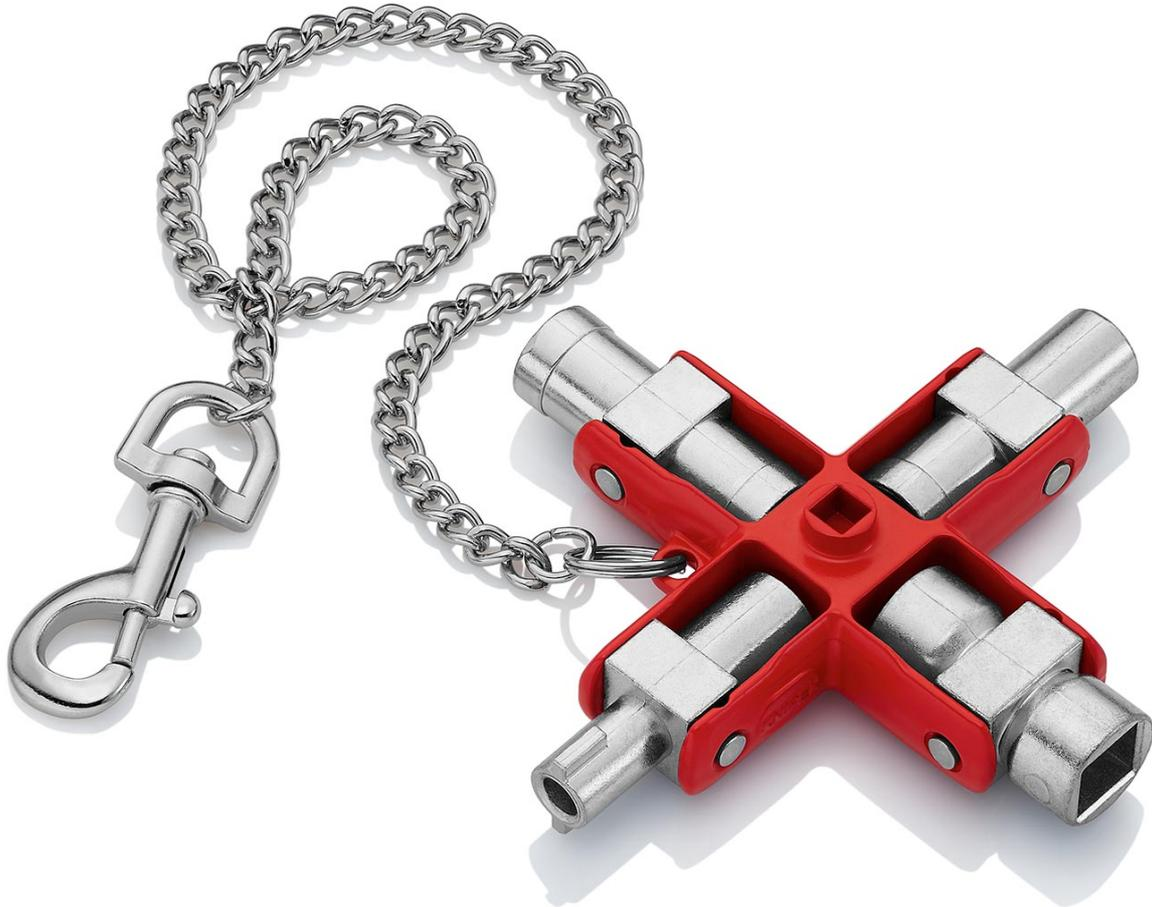
Für Schließsysteme in der Elektrotechnik, Gas- und Wasserversorgung, Klima- und Belüftungstechnik, Industrie, Gebäudetechnik usw.. Neun verschiedene Schließungen aus Zink-Druckguß in einem Schlüssel. Mit abnehmbarer Kette und Karabinerhaken. Armlänge gesamt: 90 mm. - Kapazität Vierkant: 5,0 / 6,0 / 7,0 - 8,0 / 9,0 - 10,0mm - Kapazität Doppelbart: 3 - 5mm - Kapazität Halbmond: 6mm - Kapazität Dreikant: 7,0 / 8,0 - 9,0 / 10,0 - 11,0mm
