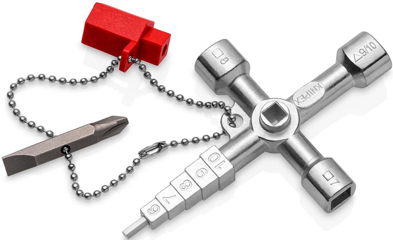
Profi-Key Schlüssel für die Bereiche Heizung-, Klima-, Sanitär- und Gebäudetechnik, z. B. für Tür- und Fenstergriffe oder zur Heizungsentlüftung. Mit Bit-Einsatz: Schlitz 1,0 x 7 mm und Kreuzschlitz PH2. Mit Adapter für 1/4"-Bits an einer Befestigungskette. Zusätzliche Bitaufnahme für 1/4"-Bits in einem Arm. Armlänge gesamt: 90 mm. - Kapazität Vierkant: 5,0 / 7,0 / 8,0mm - Kapazität Stufen-Vierkant: 6mm - Kapazität Dreikant: 9,0 - 10,0mm
