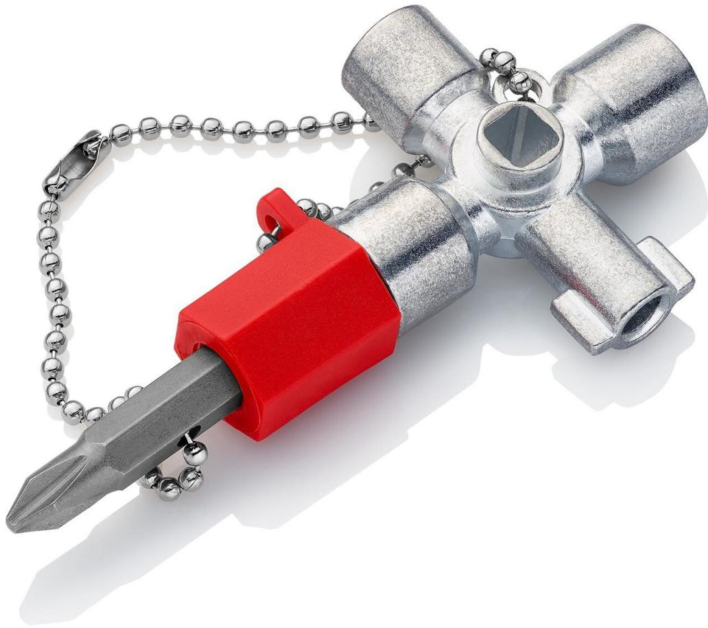
Für Schaltschränke, Absperrsysteme der Gas-, Wasser- und Elektrizitätsversorgung. Für technische Anlagen in Gebäuden wie Klima- und Belüftungsanlagen, Absperrventile, Netzschattafeln usw.. Mit Bit-Einsatz: Schlitz 1,0 x 7 mm und Kreuzschlitz PH2. Mit Adapter für 1/4"-Bits an einer Befestigungskette. Zusätzliche Bitaufnahme für 1/4"-Bits in einem Arm. kurze Ausführung, Armlänge gesamt: 44 mm. - Kapazität Vierkant: 6,0 / 8,0mm - Kapazität Doppelbart: 3 - 5mm - Kapazität Dreikant: 9,0mm
