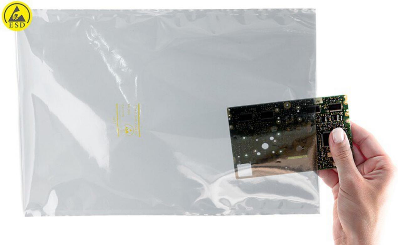
Der ESD Beutel von SafeGuard verhindert aufgrund der abschirmenden Eigenschaften das Eindringen von Spannung. Auf dem ESD Beutel sind das ESD und Recycle-Symbol, sowie die Typen- und LOT-Nr. aufgedruckt. Die Abschirmung beträgt  $<15$  nJ und die Folie weist eine Stärke von  $50\mu\text{m}$  +/- 10 % auf.
