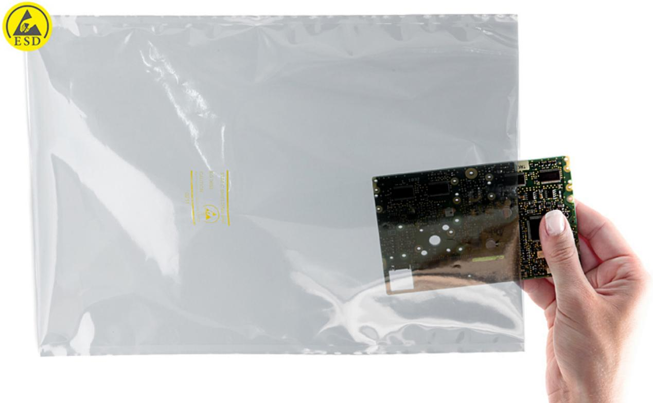
Der ESD Beutel von SafeGuard verhindert aufgrund der abschirmenden Eigenschaften das Eindringen von Spannung. Auf dem ESD Beutel sind das ESD und Recycle-Symbol, sowie die Typen- und LOT-Nr. aufgedruckt. Die Abschirmung beträgt  $<15$  nJ und die Folie weist eine Stärke von  $50\mu\text{m} \pm 10\%$  auf.
