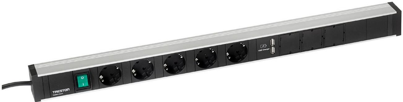
Energieleiste mit 5 Schuko-Steckdosen, Schalter und 2xUSB-Ladegerät. 4,5 m langes Netzkabel. Ideal zur Befestigung am M750 Rasterrohrmodul oder Aluminiumprofil.
