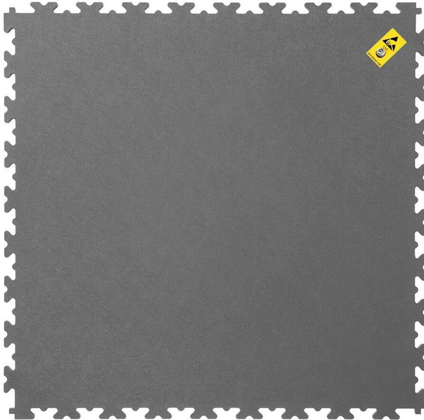
Die 7 mm ESD X-Lock Erdungsfliese wird alle 50 Quadratmeter verwendet. Die Erdungsfliese kann über einem Erdungskabel an einem Erdungsstecker oder Erdungsschiene, gemäß Verlegeanleitung, mit der Erdung verbunden werden.
