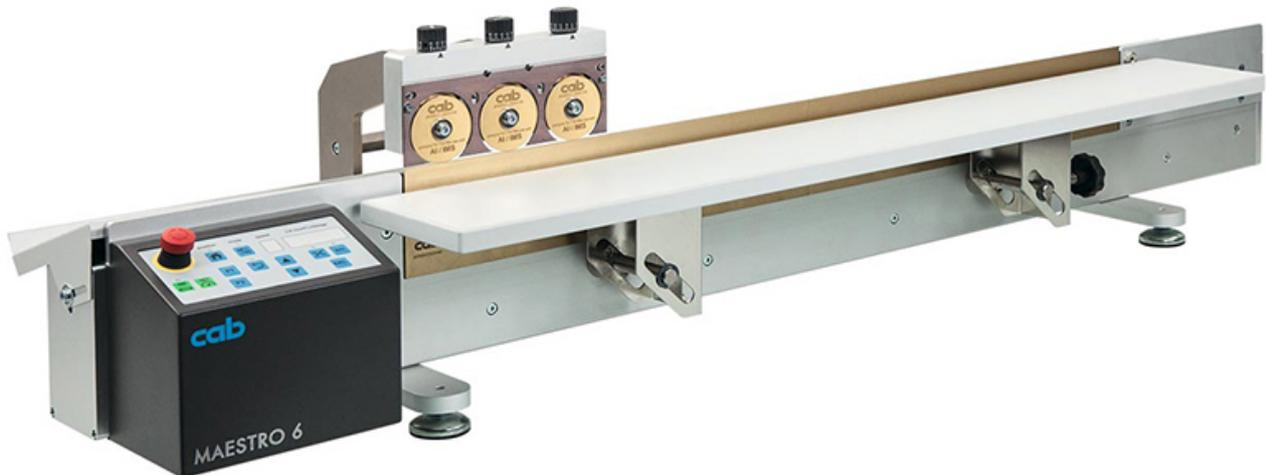
Trennen vorgeritzter Leiterplatten bis 1.500 mm Länge bei geringster Beanspruchung der Bauteile
