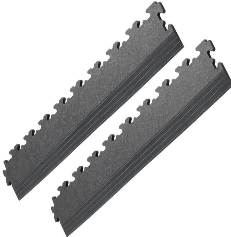
Die 7 mm X-Log Bodenrampe wurde entwickelt, um eine sichere, schräge Rampe auf Ihre ESD-Bodenfliesen zu schaffen. Jede Rampe wird mit einer Fliese durch die X-Log Technik verbunden. Wir empfehlen, Bodenrampen bei Türöffnungen und großen Übergängen zu verwenden, um Stolperfallen zu vermeiden. Eine Bodenrampe ist 500 mm lang und lässt sich fast nahtlos mit einer ganzen Fliese verbinden.
