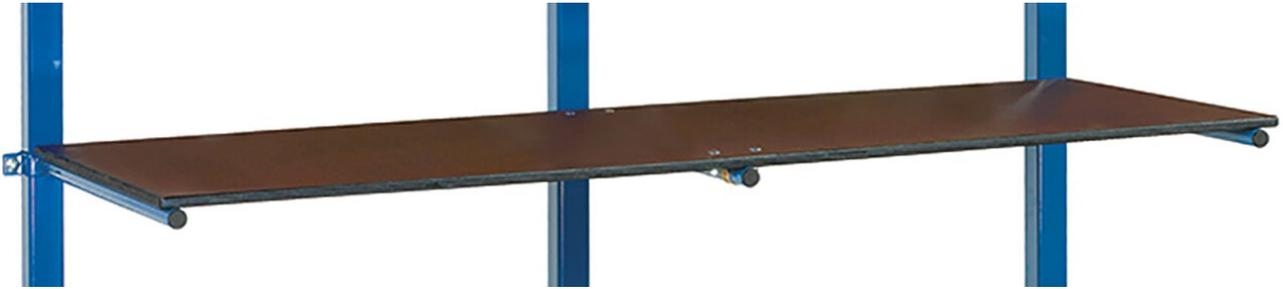
Zubehör für Standard-Tragarmwagen: Holzböden aus wasserfestem Sperrholz 15 mm stark, beidseitig verwendbar, eine Seite ist glatt, eine Seite ist rutschhemmend (Siebdruck), mit Befestigungsschellen.
