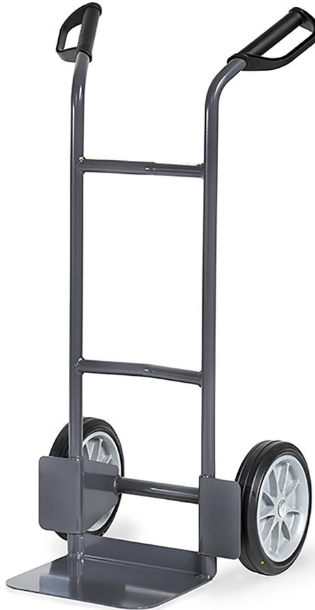
ESD-Stahlrohrkarre mit Stahlblechschaufel, stabile Schweißkonstruktion, elektrisch leitfähig pulverbeschichtet, schiefergrau RAL 7015. ESD-Sicherheitsgriffe. Stahlblechschaufel verschraubt und dadurch austauschbar. Räder mit ESD-Vollgummibereifung, auf Kunststoff-Felgen, Naben mit Rollenlagerung. Bügel oben und Querstreben durchgebogen. Für den sicheren Transport von runden Gütern, wie Rollen, Kannen, Eimern usw.
