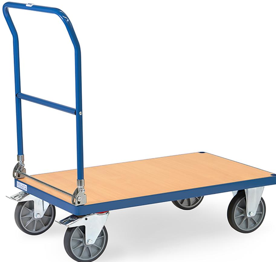
Klappwagen aus Stahlrohr und Profilstahl geschweißt, pulverbeschichtet brillantblau RAL 5007. Ladefläche aus Holzwerkstoffplatte, Oberfläche Buchendekor. Schiebebügel auf Plattform klappbar. 2 Lenk- und 2 Bockrollen, TPE-Bereifung (spurlos), Naben mit Rillenkugellager. Feststeller an den Lenkrollen, gemäß der Europäischen Norm EN 1757-3 (Sicherheit von Plattformwagen).
