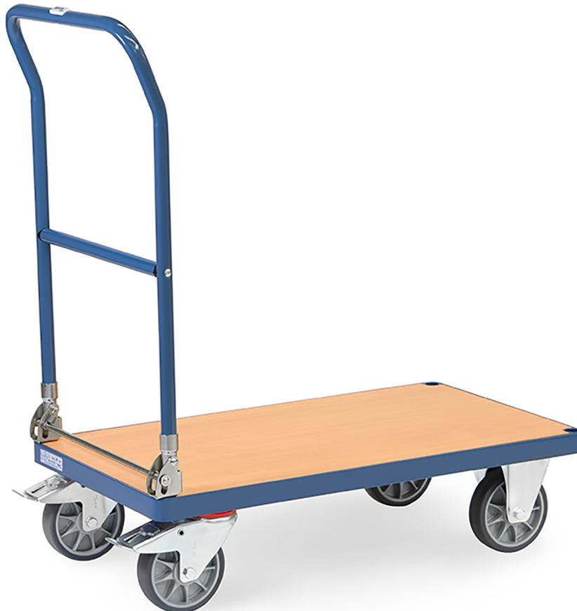
Klappwagen aus Stahlrohr und Profilstahl geschweißt, pulverbeschichtet brillantblau RAL 5007. Ladefläche aus Holzwerkstoffplatte, Oberfläche Buchendekor. Schiebebügel auf Plattform klappbar. 2 Lenk- und 2 Bockrollen, TPE-Bereifung (spurlos), Naben mit Rillenkugellager. Feststeller an den Lenkrollen, gemäß der Europäischen Norm EN 1757-3 (Sicherheit von Plattformwagen).
