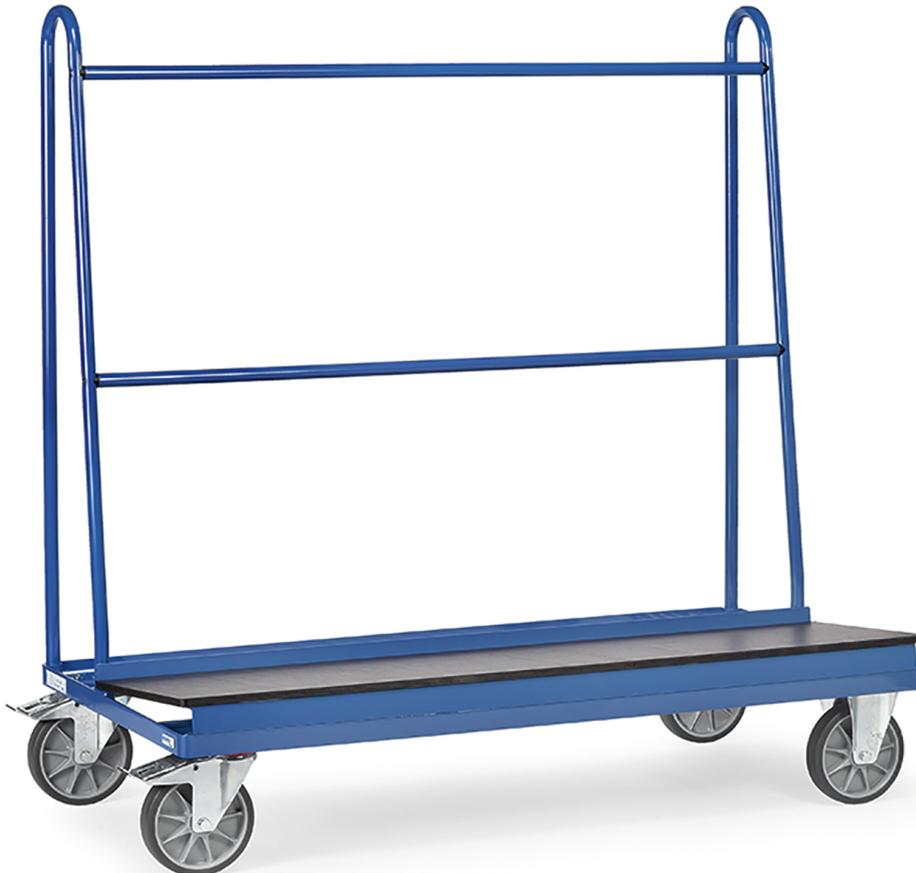
Baukasten-System: zum sicheren Transport von Glasscheiben, Holz- und Kunststoffplatten sowie kompletter Fenster und Türen. Profilstahl und Stahlrohr geschweißt. Pulverbeschichtet, blau RAL 5007. Einseitige Anlagen mit Profilgummi belegt. Auflagebreite 430 mm, Anlagehöhe 1450 mm. 2 Lenk- und 2 Bockrollen, Vollgummi-Elastic-Bereifung, blaugrau "spurlos", Naben mit Kugellager. Feststeller an den Lenkrollen, gemäß der Europäischen Norm EN 1757-3 (Sicherheit von Plattformwagen).
