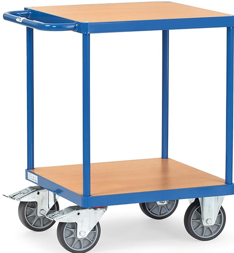
Stahlrohr und Profilstahl geschweißt, pulverbeschichtet RAL 5007. 2 Plattformen aus Holzwerkstoffplatte, Oberfläche Buchendekor. 2 Lenk- und 2 Bockrollen, TPE-Bereifung, Naben mit Rillenkugellager. Feststeller an den Lenkrollen, gemäß der Europäischen Norm EN 1757-3 (Sicherheit von Plattformwagen). Tragkraft obere Ladefläche 200 kg.
