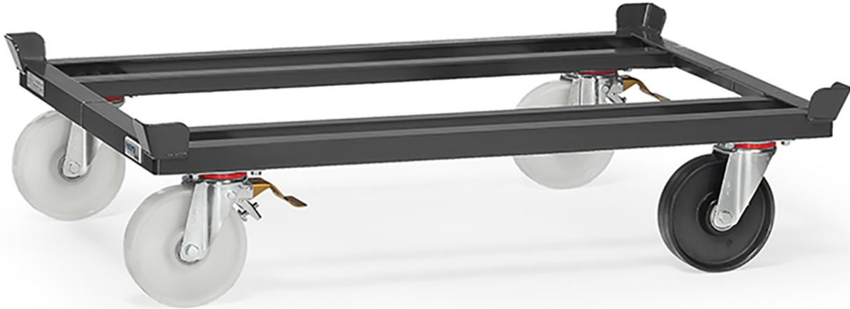
Robuste Winkelstahl-Schweißkonstruktion, mit 4 Fangecken. Pulverbeschichtet anthrazitgrau RAL 7016. 3 Lenkrollen mit Polyamid-Rädern, Naben mit Präzisionskugellager. 2 Lenkrollen mit Totalfeststeller im Vorlauf, diagonal angeordnet. 1 Rolle elektrisch leitfähig, Radkörper Polypropylen schwarz, Nabe mit Präzisionskugellager. Unterfahrhöhe: 235 mm
