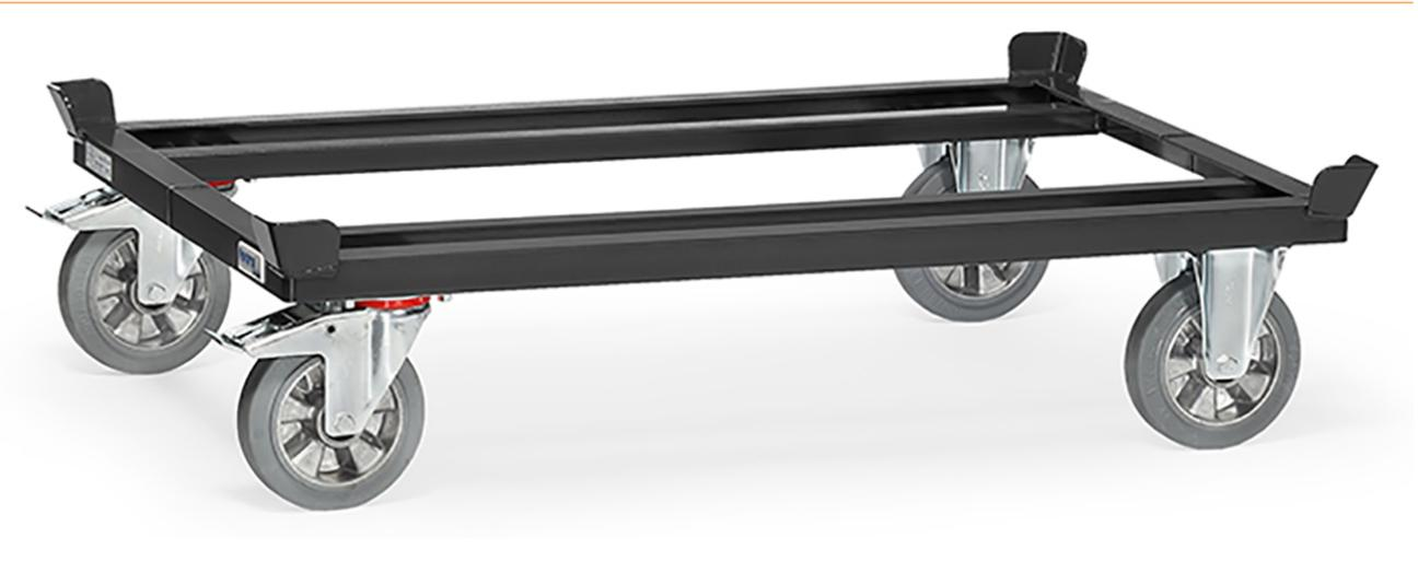
Für Flachpaletten und Gitterboxen. Robuste Winkelstahl-Schweißkonstruktion, mit 4 Fangecken, pulverbeschichtet, anthrazitgrau RAL 7016. 2 Lenk- und 2 Bockrollen, Elastic-Vollgummi-Bereifung, Naben mit Kugellager, blaugrau "spurlos", Feststeller an den Lenkrollen, gemäß der europäischen Norm EN 1757-3 (Sicherheit von Plattformwagen). Geringer Rollwiderstand, elastischer Lauf, keine Fahrgeräusche.
