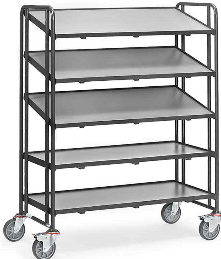
Baukasten-System: Stahlrohr und Profilstahl geschweißt, pulverbeschichtet anthrazitgrau RAL 7016, Schraubkonstruktion. 5 Etagenrahmen mit Holzwerkstoffplatten, Rand 13 mm hoch. Variabel einschraubbare Etagen, Raster 150 mm, Neigung bei schrägem Einbau 15° oder 30°. Tragkraft pro Ladefläche 60 kg. 4 Lenkrollen, TPE-Bereifung, Naben mit Rillenkugellager. 2 Stück mit Feststeller, gemäß der Europäischen Norm EN 1757-3 (Sicherheit von Plattformwagen).
