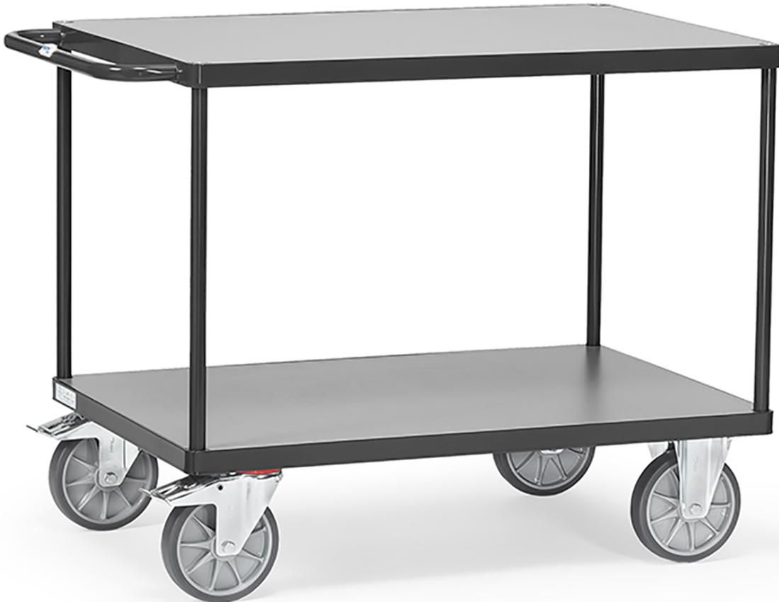
Stahlrohr und Profilstahl geschweißt, pulverbeschichtet RAL 7016. 2 Plattformen aus Holzwerkstoffplatte, Oberfläche mittelgrau. 2 Lenk- und 2 Bockrollen, TPE-Bereifung, Naben mit Rillenkugellager. Feststeller an den Lenkrollen, gemäß der Europäischen Norm EN 1757-3 (Sicherheit von Plattformwagen). Tragkraft obere Ladefläche 200 kg.
