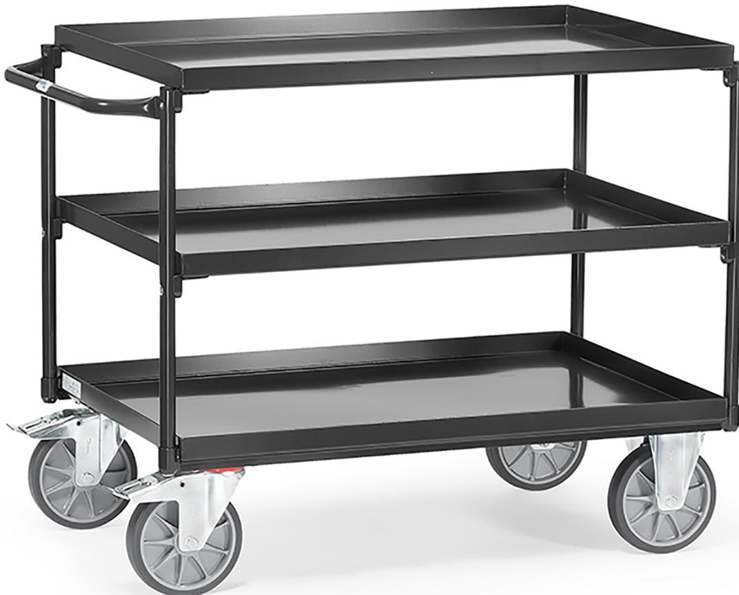
Tischwagen Stahlkonstruktion geschweißt. Mit 3 Stahlblechwannen. Stahlrohrbügel und Stahlblechwannen verschraubt. Wannen öldicht, Rand 40 mm hoch. Pulverbeschichtet anthrazitgrau RAL 7016. Schiebegriff waagrecht. 2 Lenk- und 2 Bockrollen, TPE-Bereifung, Naben mit Rillenkugellager. Feststeller an den Lenkrollen, gemäß EN 1757-3 (Sicherheit von Plattformwagen). Tragkraft obere und mittlere Ladefläche 200 kg.
