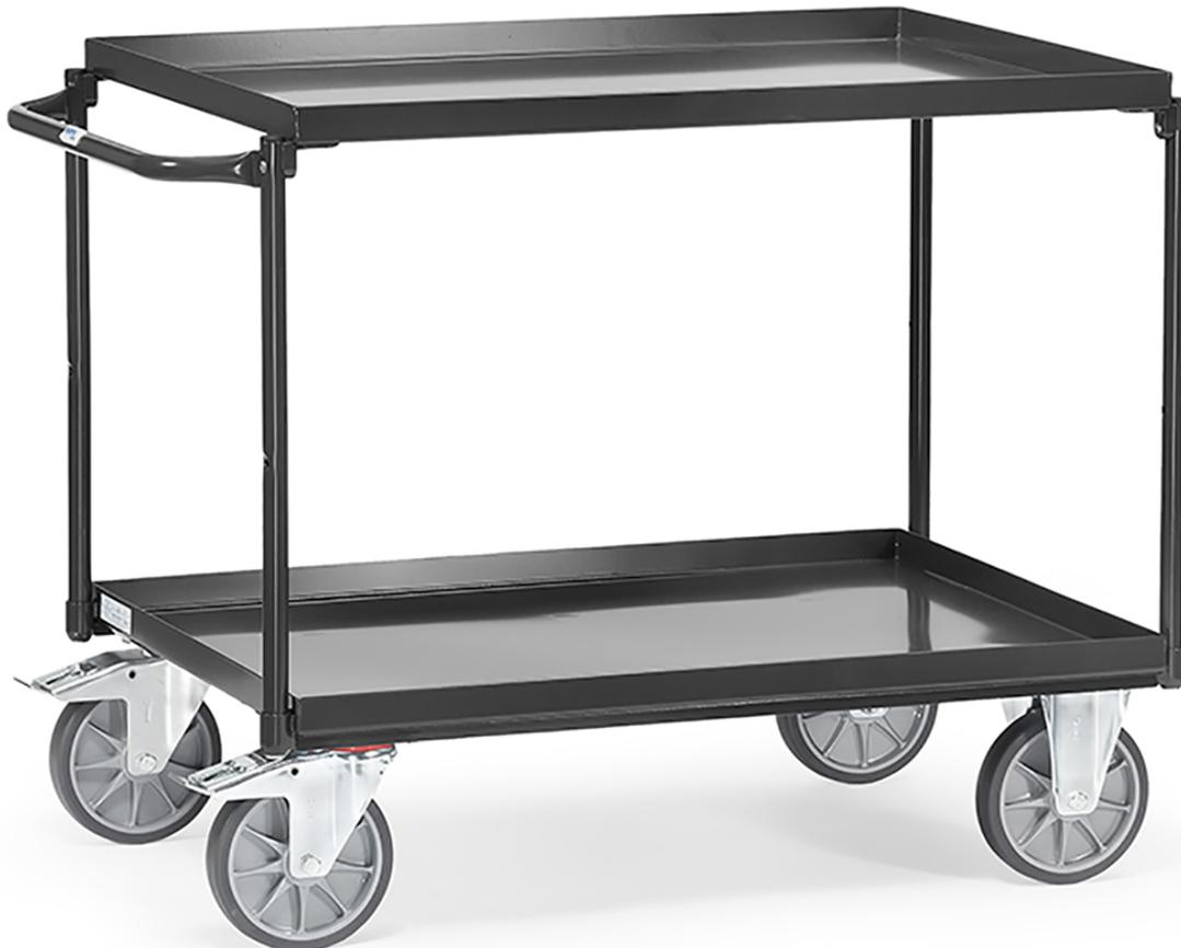
Stahlkonstruktion geschweißt. Mit 2 Stahlblechwannen. Stahlrohrbügel und Stahlblechwannen verschraubt. Wannen öldicht, Rand 40 mm hoch. Pulverbeschichtet RAL 7016 anthrazitgrau. Schiebegriff waagrecht. 2 Lenk- und 2 Bockrollen, TPE-Bereifung, Naben mit Rillenkugellager. Feststeller an den Lenkrollen, gemäß EN 1757-3 (Sicherheit von Plattformwagen). Tragkraft obere Ladefläche 200 kg.
