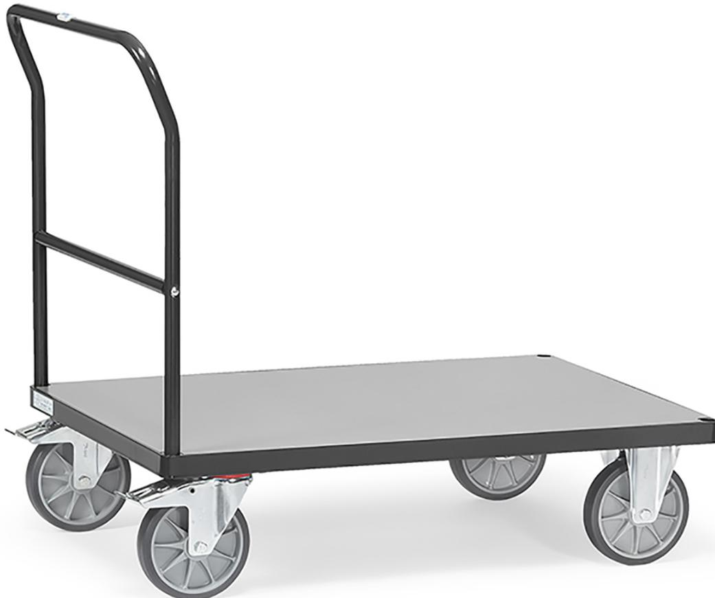
Schiebebügelwagen aus Stahlrohr und Profilstahl geschweißt, pulverbeschichtet anthrazitgrau RAL 7016. Plattform Holzwerkstoffplatte, Oberfläche mittelgrau. 2 Lenk- und 2 Bockrollen, TPE-Bereifung, Naben mit Rillenkugellager. Feststeller an den Lenkrollen, gemäß der Europäischen Norm EN 1757-3 (Sicherheit von Plattformwagen).
