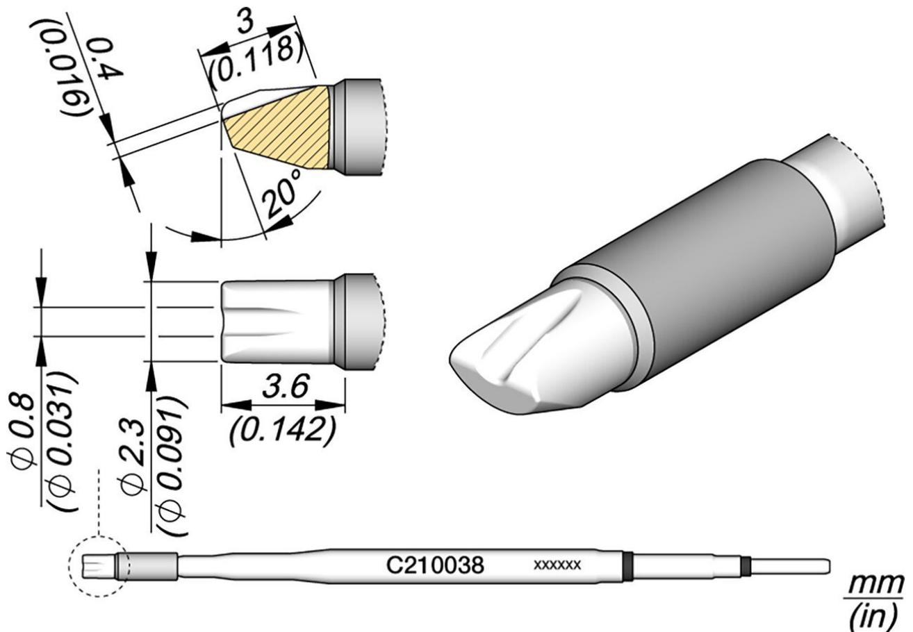
Sie ist speziell für das Lötten von Kabeln und Anschlüssen mit einem Durchmesser von bis zu 0,8 mm konzipiert.
