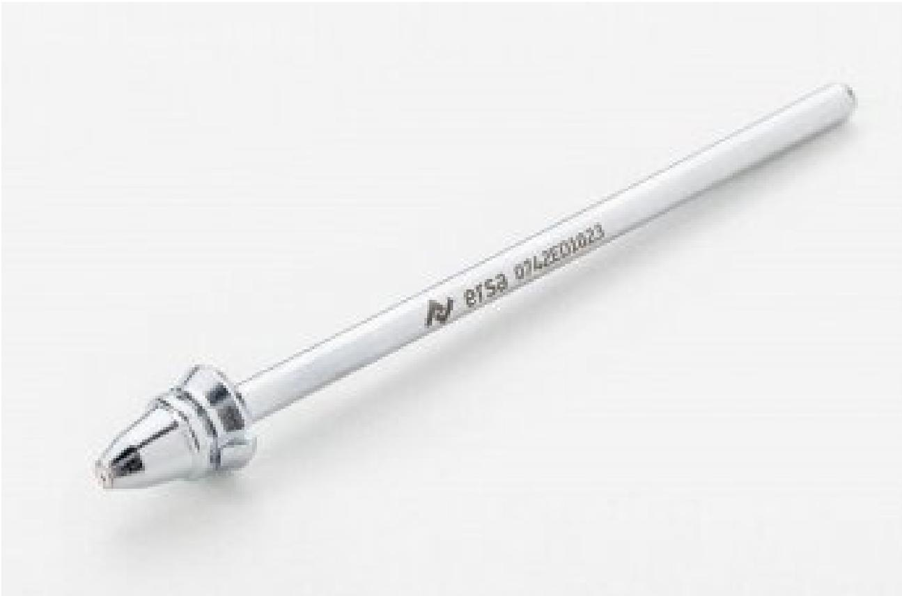
ERSADUR-Lötpitzen sind für Dauerbetrieb geschaffen. In einem speziellen, von Ersal entwickelten Verfahren werden sie auf galvanischem Weg mit einer Eisenschicht plattiert und durch eine zusätzliche Chromschicht vor Korrosion und Oxidation geschützt. Perfekter Wärmetransfer schützt den Heizkörper des Lötkolbens vor Überlastung und vorzeitigem Verschleiß.
