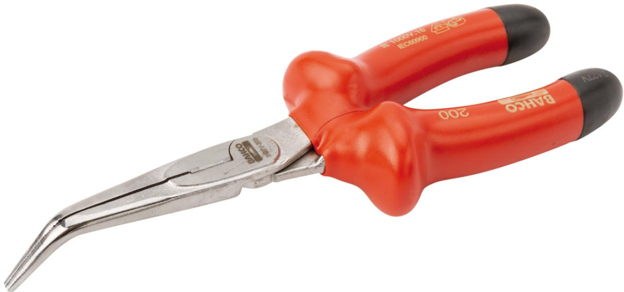
3-lagige Beschichtung mit unterschiedlichen Farben zur Anzeige der Anwendungssicherheit: sicher, gefährlich oder sehr gefährlich. Eine vierte, schwarze Schicht zum zusätzlichen Schutz der Griffkanten
