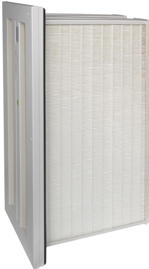
Die angesaugte Luft strömt durch den HEPA-Filter im sasoo. Aerosole, Viren und andere extrem feine Partikel im Nanobereich werden mit einem Abscheidegrad von 99,995 % aus der Luft gefiltert.
