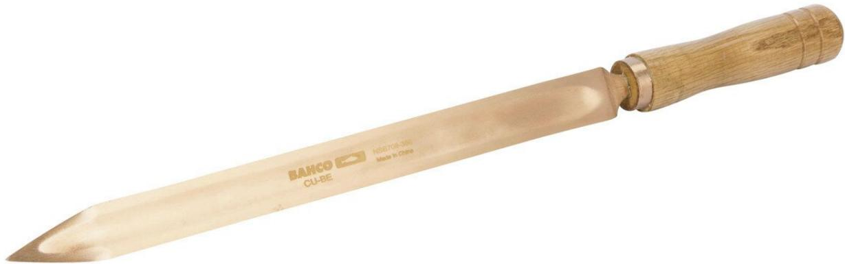
Funkenfreie Werkzeuge werden in Bereichen eingesetzt, in denen durch Funkenflug eine potenzielle Feuer- und Explosionsgefahr besteht. Dreikantschaber aus Kupferberyllium, funkenfrei, 450 mm.
