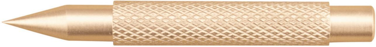
Funkenfreie Werkzeuge werden in Bereichen eingesetzt, in denen durch Funkenflug eine potenzielle Feuer- und Explosionsgefahr besteht. Körner aus Kupferberyllium, 100 mm.
