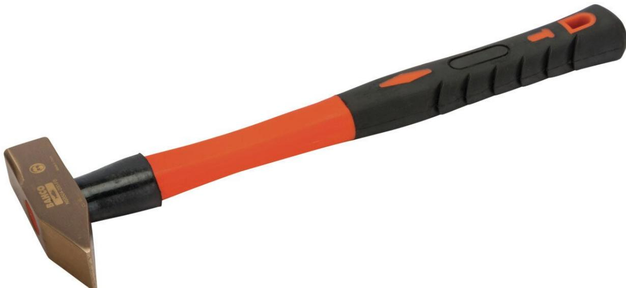
Funkenfreie Werkzeuge werden in Bereichen eingesetzt, in denen durch Funkenflug eine potenzielle Feuer- und Explosionsgefahr besteht. Schlosserhammer mit Kupferberyllium-Kopf und Fiberglas-Griff, funkenfrei, 100 g.
