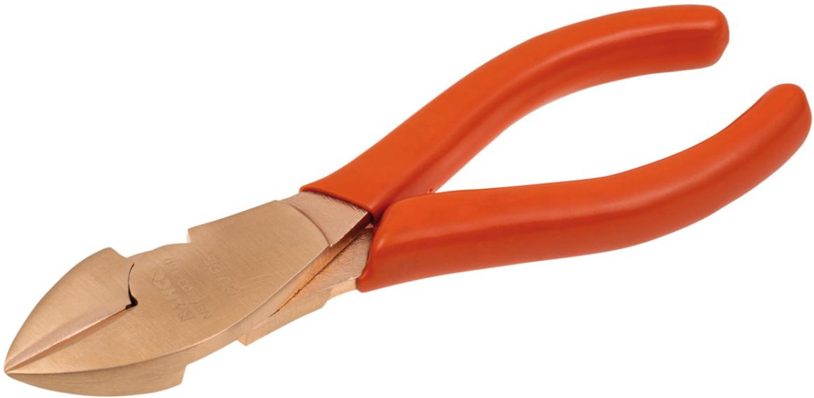
Funkenfreie Werkzeuge werden in Bereichen eingesetzt, in denen durch Funkenflug eine potenzielle Feuer- und Explosionsgefahr besteht. Hochleistungs-Seitenschneider aus Kupferberyllium, funkenfrei, 160 mm.
