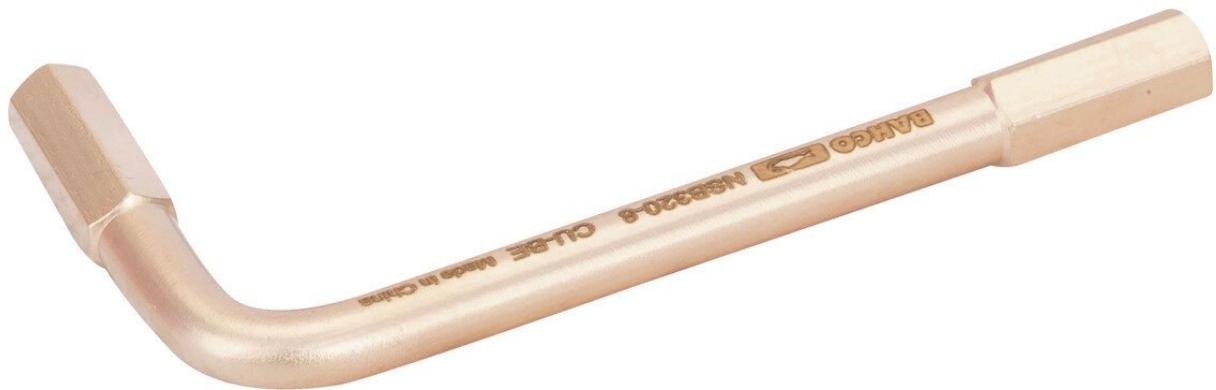
Funkenfreie Werkzeuge werden in Bereichen eingesetzt, in denen durch Funkenflug eine potenzielle Feuer- und Explosionsgefahr besteht. Winkelschraubendreher aus Kupferberyllium, funkenfrei, 3 mm.
